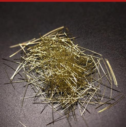
Microfibras de aço cromado, obtidas do corte de fio metálico, para reforço estrutural de conglomerados de cimento em geral. Readymesh MR se apresenta como fios de aço muito finos banhados a latão com um diâmetro de 0,22 mm e um comprimento de 6 o 20 mm, usados principalmente para reforçar betão e argamassas de alto desempenho. Readymesh MR estão disponíveis em dois comprimentos diferentes: Readymesh MR-060 = 6 mm; Readymesh MR-200 = 20 mm
